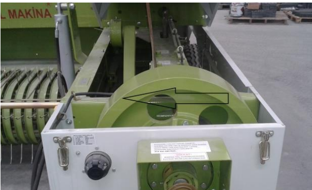
Рисунок 39. Рабочее направление маховика
