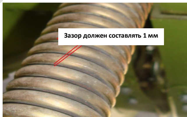
Рисунок 51. Опорная пружина подборочного устройства
