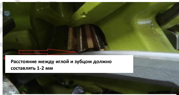
Рисунок 34. Регулировка иглы
