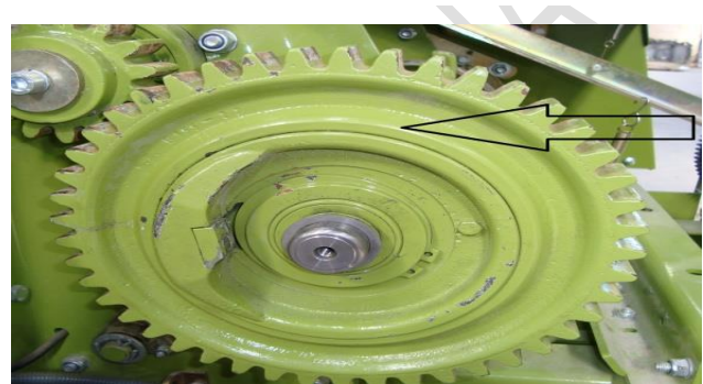
Рисунок 38. Демонтаж большого зубчатого колеса
