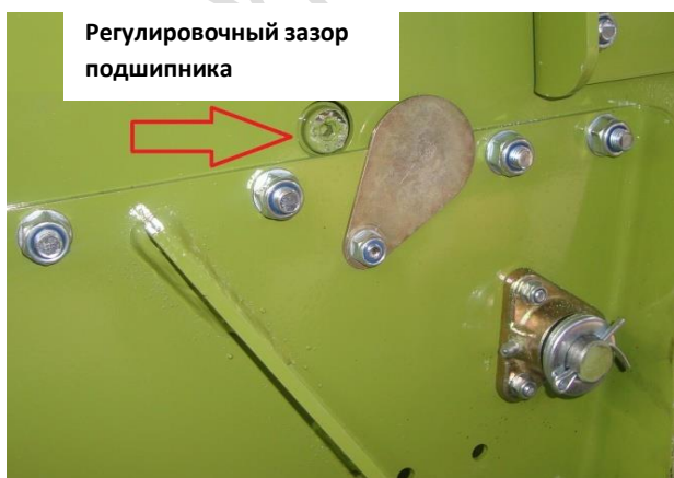
Рисунок 60. Регулировочный зазор подшипника
